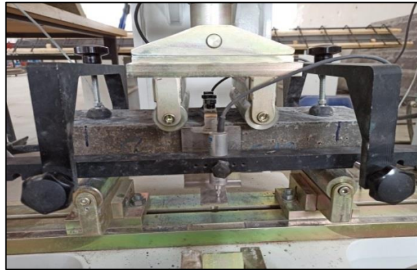
Şekil 3. Dört Noktalı Eğilme Deneyi (The Four-Point Flexural Test)
