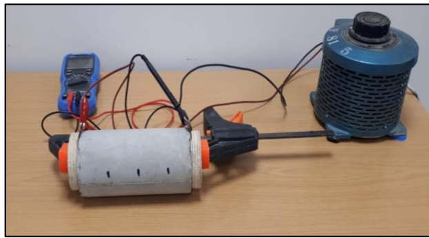
Şekil 5. Isıtma Deney Düzeneği (Heating Test Setup)
