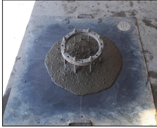
Şekil 2. J-Halkası Deneyi (J-Ring Test)
