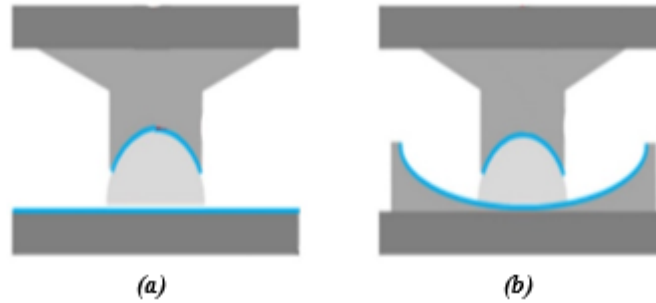
Şekil 1. (a) Düz yüzeyle ve (b) eğri yüzeyle sürtünmeli sarkaç izolator
