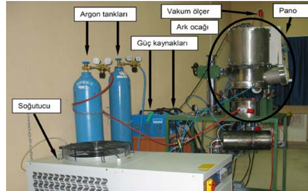
Şekil 1. Tasarımı yapılan ark ergitme ve döküm ocağı
