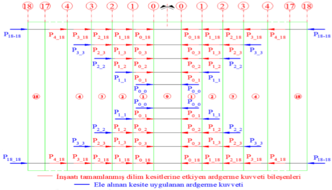
Şekil 4. Farklı yapım aşamaları sonunda uygulanan ardgerme kuvveti ve bileşenleri-tabliye plan görüntüsü
