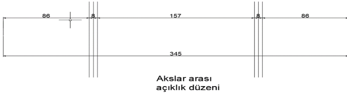
Şekil 9. Akslar arası açıklık düzeni (birimler m cinsindedir)
