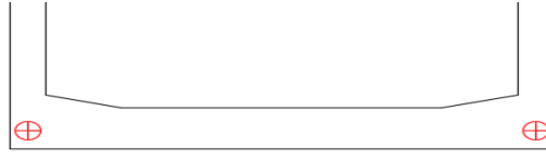
Şekil 17. Kesit altı halat yerleşim planı
