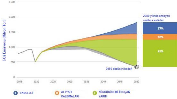
Şekil 1. Uçaklarda karbondioksit emisyonunu düşürmek için yol haritası
