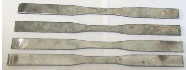
Figure 2. Steel specimens prepared for tensile testing (Şekil 2. Çekme testi için hazırlanmış çelik numuneler)
