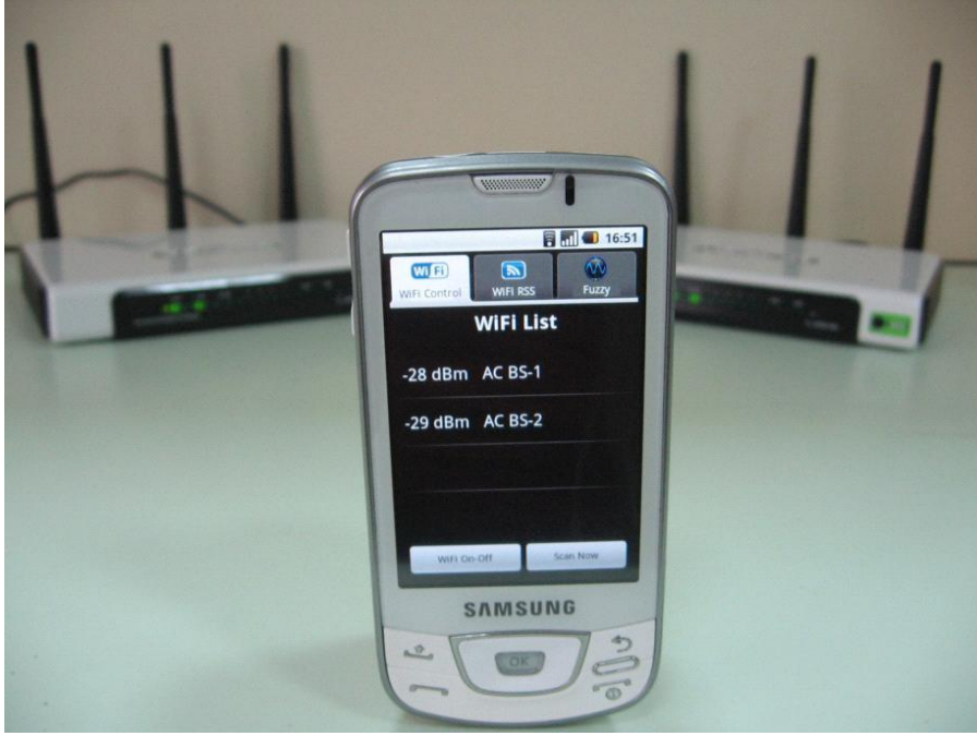
Figure 1. Android phone with the application and Wi-Fi APs (Şekil 1. Android telefon, Wi-Fi erişim noktaları ve uygulama)
