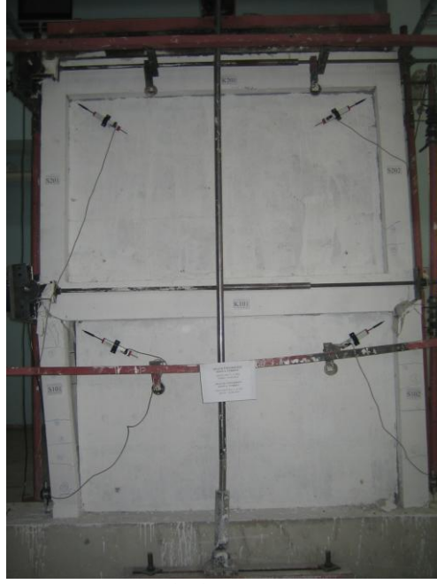
Şekil 13. 2 nolu deney numunesinin (A-TPÇ) deneyden sonraki görünüşü (Figure 13. The appearance of specimen 2 (A-TPF) after the test)
