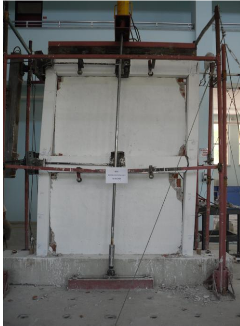
Şekil 8. 1 nolu deney numunesinin (RN) deneyden sonraki görünüşü (Figure 8. The appearance of specimen 1 (RS) after the test)
