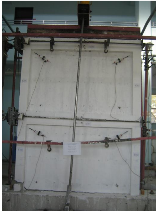
Şekil 18. 3 nolu deney numunesinin (B-TPÇ) deneyden sonraki görünüşü (Figure 18. The appearance of specimen 3 (B-TPF) after the test)
