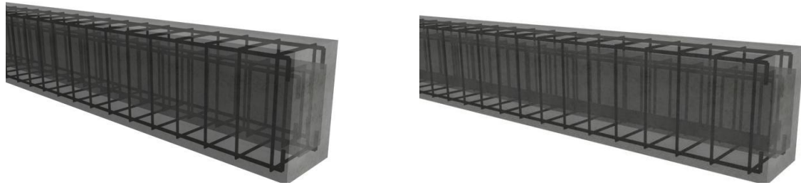
Şekil 3. Mantolanan kiriş numunesinin genel görünümü (2 \phi 10 - 3 \phi 10) (Figure 3. View general of the beam samples jacketed (2 \phi 10 - 3 \phi 10))
