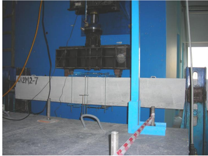
Şekil 10. Mantolanan kiriş numunelerinin deney başlamadan önceki son hali (Figure 10. Manipulative final before the start of the experiment of the jacketed beam sample)
