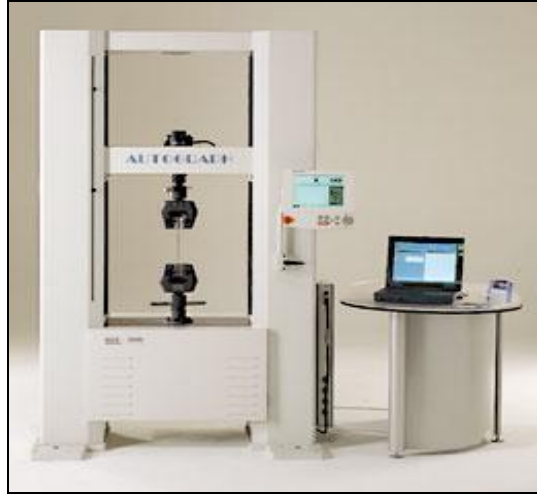
Şekil 3. Bulk numunelerin çekilmesinde kullanılan universal çekme cihazı [11]
