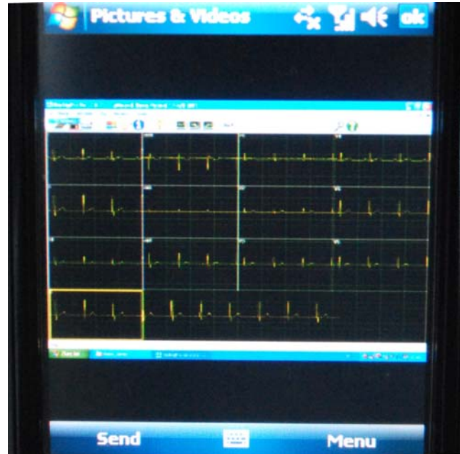
Şekil 5. 12 derivasyonlu EKG grafiğinin PDA’ya aktarılması (Figure 5. Sending 12 derivation EKG graphic to PDA)
