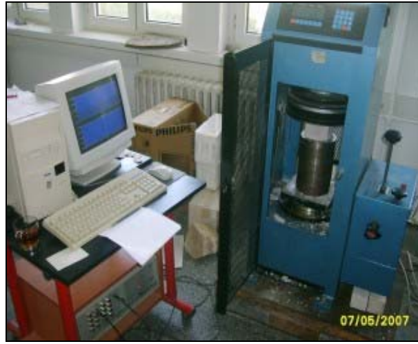
Şekil 3. Elastisite modülünü belirlemek için kullanılan pres (Figure 3. The pres used to determine elasticity modulus)
