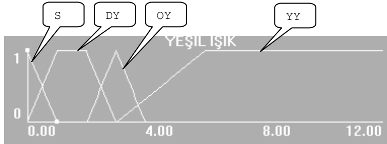
Şekil 3. Yeşil ışık araç yoğunluğu için üyelik fonksiyonu (Figure 3. The membership function for the green light car density)
