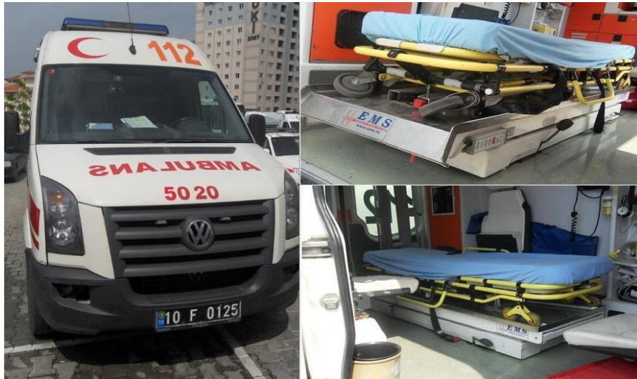
Şekil 13. Hidrolik süspansiyonlu sedye sistemi [1] (Figure 13. Stretcher system with hydraulic suspension [1])
