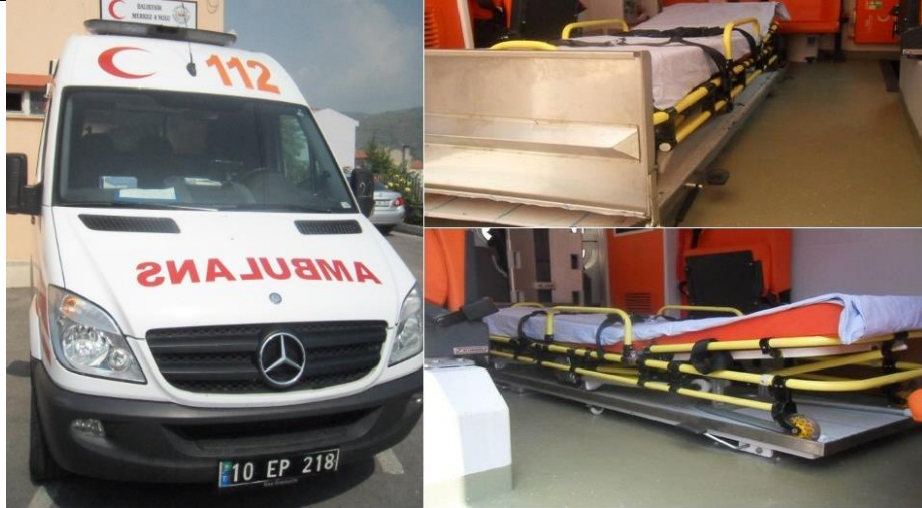
Şekil 11. İki yön hareketli platformlu sedye sistemi (Figure 11. Stretcher system with two directional movement platform [1])
