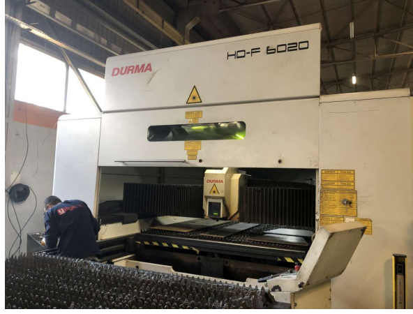
Şekil 2. Durma HD-F 6020 fiber lazer tezgâhı
