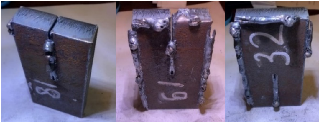
Şekil 19. 18-19-32 numaralı numunelerde çapak oluşumu
