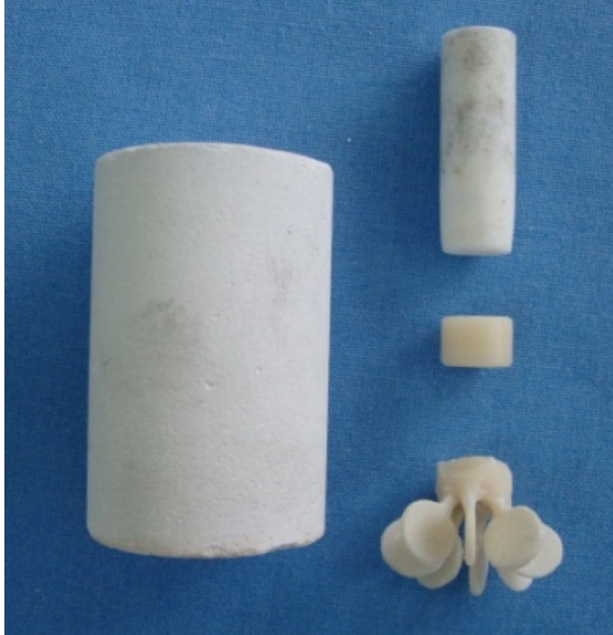
Resim 3- Preslenmiş tam seramik örnekler gösterilmektedir.
