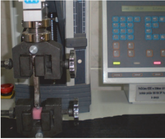
Resim 4- Örnekler üzerine çekme testi uygulaması.
