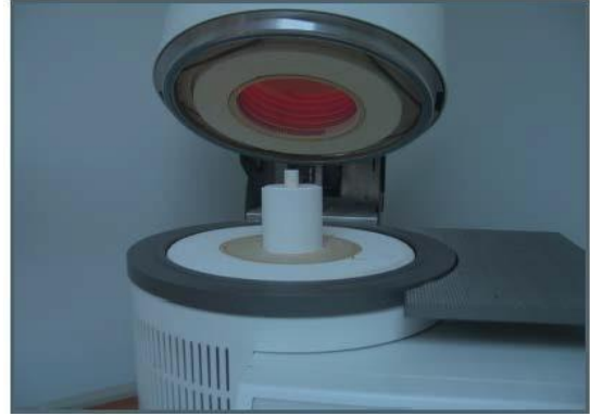
Fig. 2. IPS e-max tam seramik örneklerin hazırlandığı EP 600 fırını.
