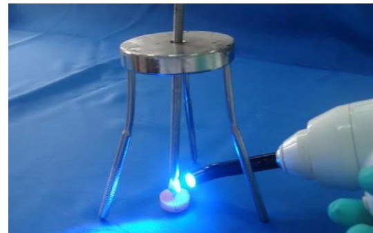
Fig. 8. Kronların simantasyonunda kuvvetin standardizasyonu sağlamak amacıyla kullanılan üç ayakta oluşan ve bir noktaya kuvvet uygulayabilen düzenek kullanıldı.
