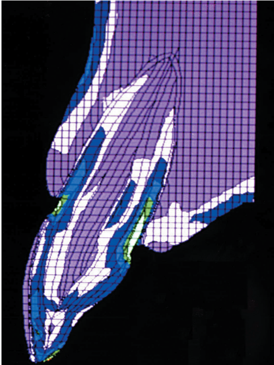
Resim 3: Labial yüzde preparasyon yapılan kompozit laminate veneer kronların (durum 2b-3b) makaslama gerilim dağılımı.
