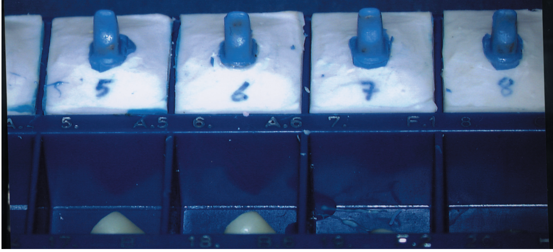
Şekil 3: Yapıştırma siman tabakasını yansıtan silikon material (mavi renkli).
