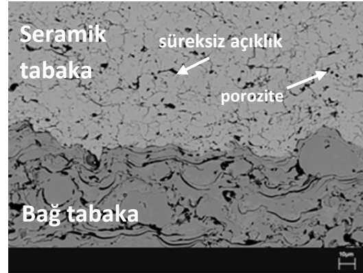
Şekil 2. APS tekniğiyle üretilen TBC'ye ait ara yüzey mikroyapısı
