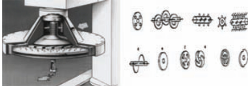
Şekil 10. Diskli karıştırıcı Pearl mill ve alternatif karıştırıcı şekilleri.
