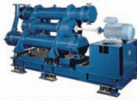
Şekil 12. Titreşimli değirmen ve kesit görüntüsü
