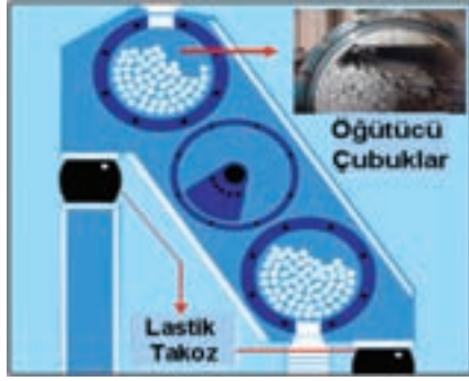
Şekil 12. Titreşimli değirmen ve kesit görüntüsü
