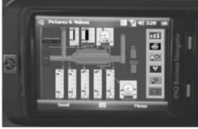
Şekil 6. PDA üzerindeki SCADA görüntüsü
