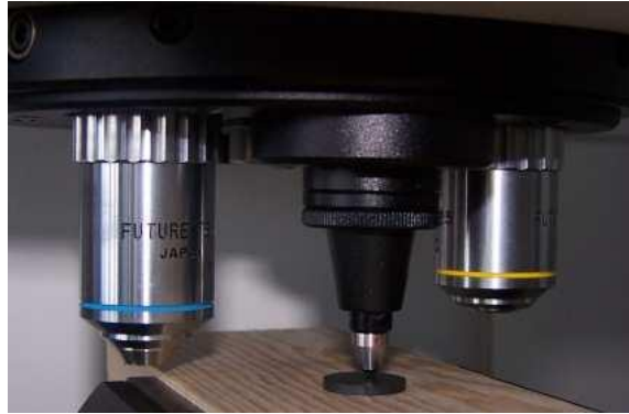
Şekil 5. %Zn ilaveli tablet biçimli numunelerden birine ait Vickers Sertlik ölçüm yapılıırken görünümü[20]
