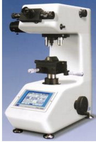
Şekil 7. Ölçümlerde kullanılan Vickers Sertlik cihazı[21]. (Figure 7. Device used in the measurement of the Vickers hardness)
