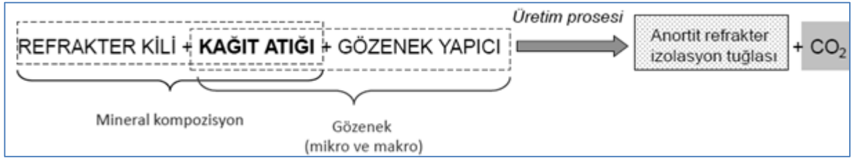
Şekil 2. Alternatif bir hammadde kaynağı olarak kağıt üretim atığı kullanılmasıyla anortit ( \text{CaO} \cdot \text{Al}_2\text{O}_3 \cdot 2\text{SiO}_2 ) refrakter izolasyon tuğlasının üretimi
