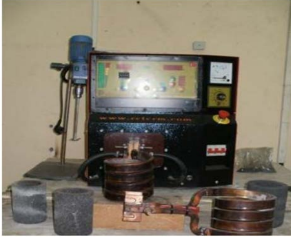
Şekil 3. Deneylerde kullanılan laboratuvar ölçekli indüksiyon ocağı
