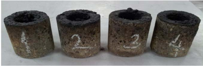
Şekil 4. Deney sonrası Mg-C potaların görünümü
