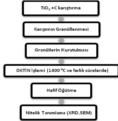
Şekil 1. DKTİN işlemi ile TiN tozu üretimi için iş akış şeması
