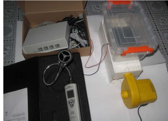
Şekil 3. Termoelektrik modüllü ve değişken hava debili su soğutucusu montaj fotoğrafı (Figure 3. Water cooler assembly photo with the thermoelectrical modulated and variable air flow rate)
