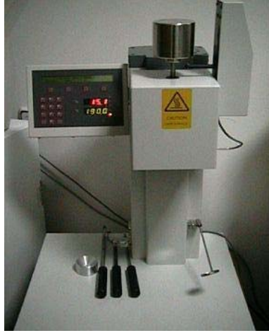
a) b) Şekil 1. ASTM D1238 ve TSE 1323 standardına göre EAİ deney cihazı. a) EAİ cihazının resmi, b) EAİ deney düzeneğinin şematik resmi [2] (Figure 1. The test apparatus of MFI according to ASTM D1238 and TSE 1323 standard a) The picture of MFI apparatus, b) The schematic view of MFI apparatus [2])
