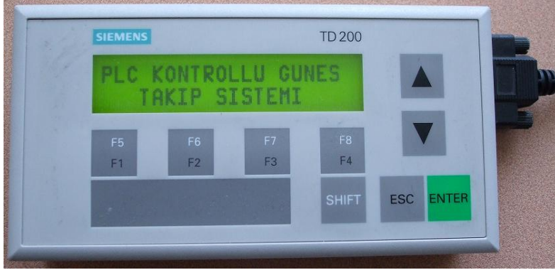
Şekil 9. Takip sistemi ilk çalıştırıldığında kontrol paneli görüntüsü (Figure 9. Screenshot of control panel at starting time)
