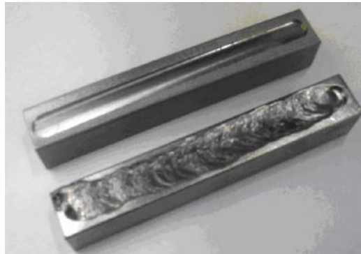
Şekil 2. Kaplama öncesi alt tabaka malzemesinin hazırlanmış durumdaki numune resmi (Figure 2. The Photographs of before coating sample)
