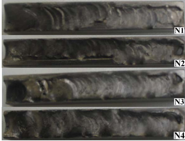
Şekil 3. Farklı üretim parametrelerinde elde edilen kaplama numunelerinin makro üst görünüşü (Figure 3. In the different manufactured parameters coating sample or macro figure)
