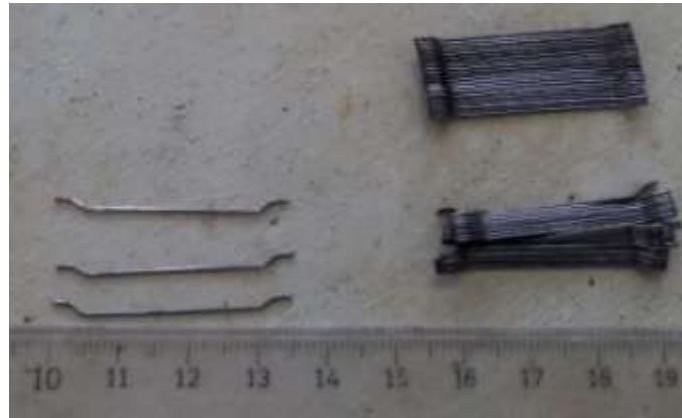
Şekil 2. SIFCON üretiminde kullanılan çelik lifler
