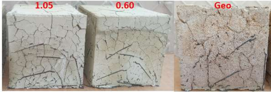
Şekil 8. Yüksek sıcaklık deneyi sonrasında SIFCON numuneler
