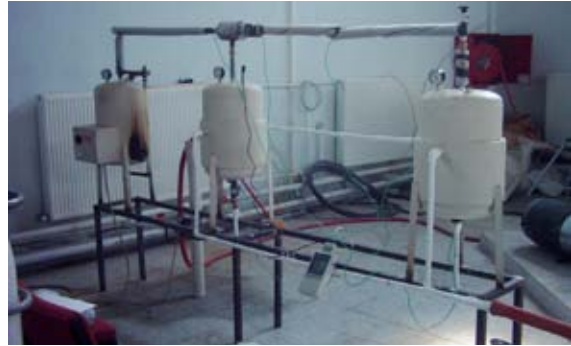
Şekil 4. Güneş enerjili ejektörlü soğutma sisteminin fotoğrafı (Üçgül, 2006).
