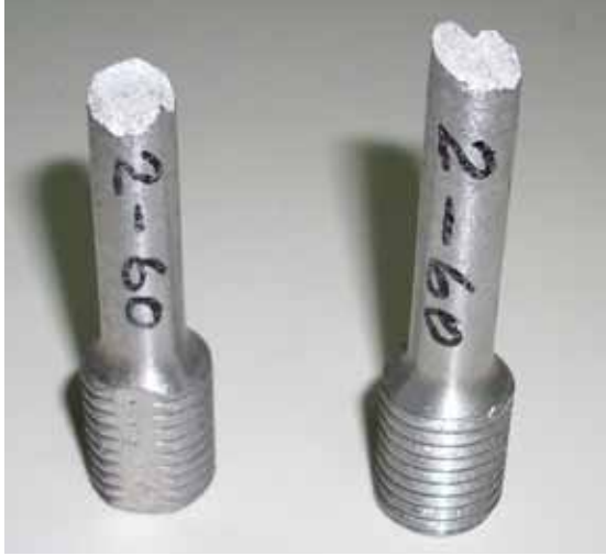
Şekil 7. Çekme testi sonrası kopan numune.
