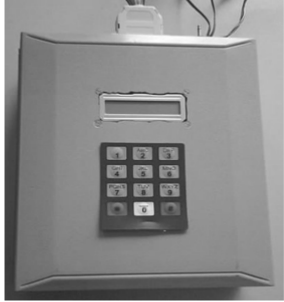
Şekil 7. TV deney setinin kontrol kutusu.
