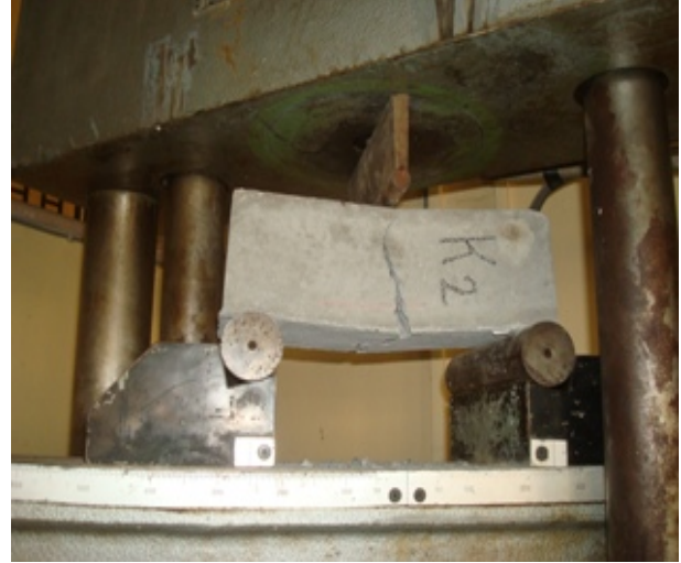
Şekil 1. Lifsiz kiriş eğilme deneyi(Lint-free beam bending test)
