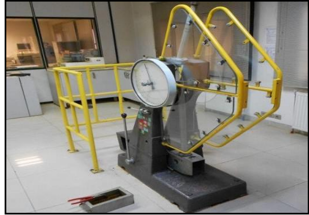
Şekil 2. Çentik darbe numune örneği ve cihazın görüntüsü
