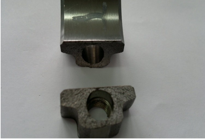
Şekil 16. Gevrek ve Klevaj Kırılma Yüzeği
