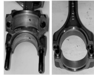
(a) Talaşlı İmalat ile İkiye Ayırma Yöntemi
