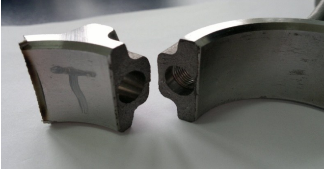
Şekil 15. Kırılmış ve SEM-Optik Analiz İçin İkiye Kesilmiş Parçalar
