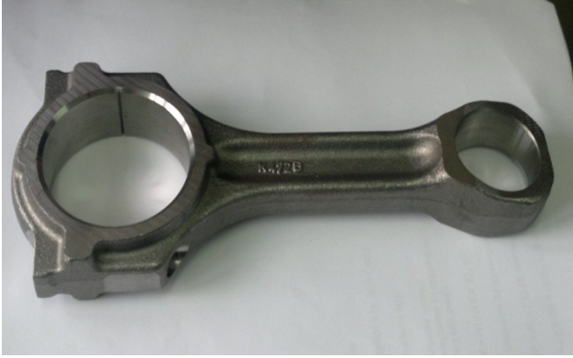
Şekil 9. Kırma Deneyinde Kullanıldığımız C70S6 Biyel Kolu
