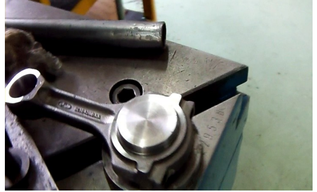
Şekil 12. Biyel ve Yaptığımız Kırma Aparatı
