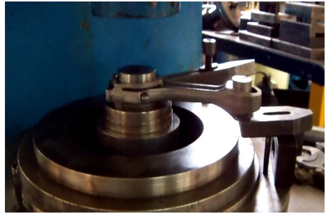
Şekil 14. Biyel ve Hazırladığımız Kırma Tertibatı
