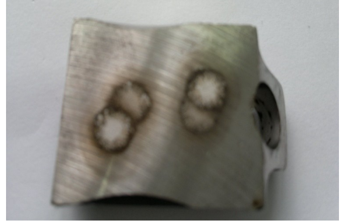
Şekil 22. Spektral Analiz Yapılan Kesilmiş ve Temizlenmiş Parça
