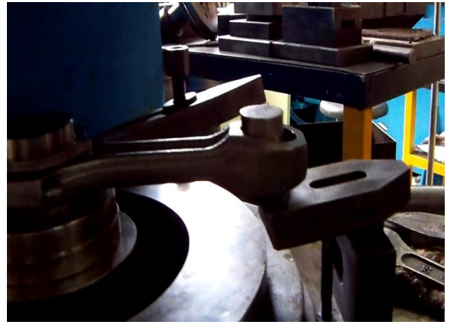
Şekil 13. Darbeli Presin Altına Yerleştirilen Biyel ve Hazırladığımız Kırma Tertibatı
