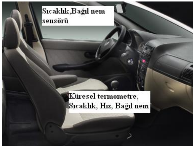
Şekil 1. Deney aletlerinin otomobil kabini içerisindeki yerleşimi.
