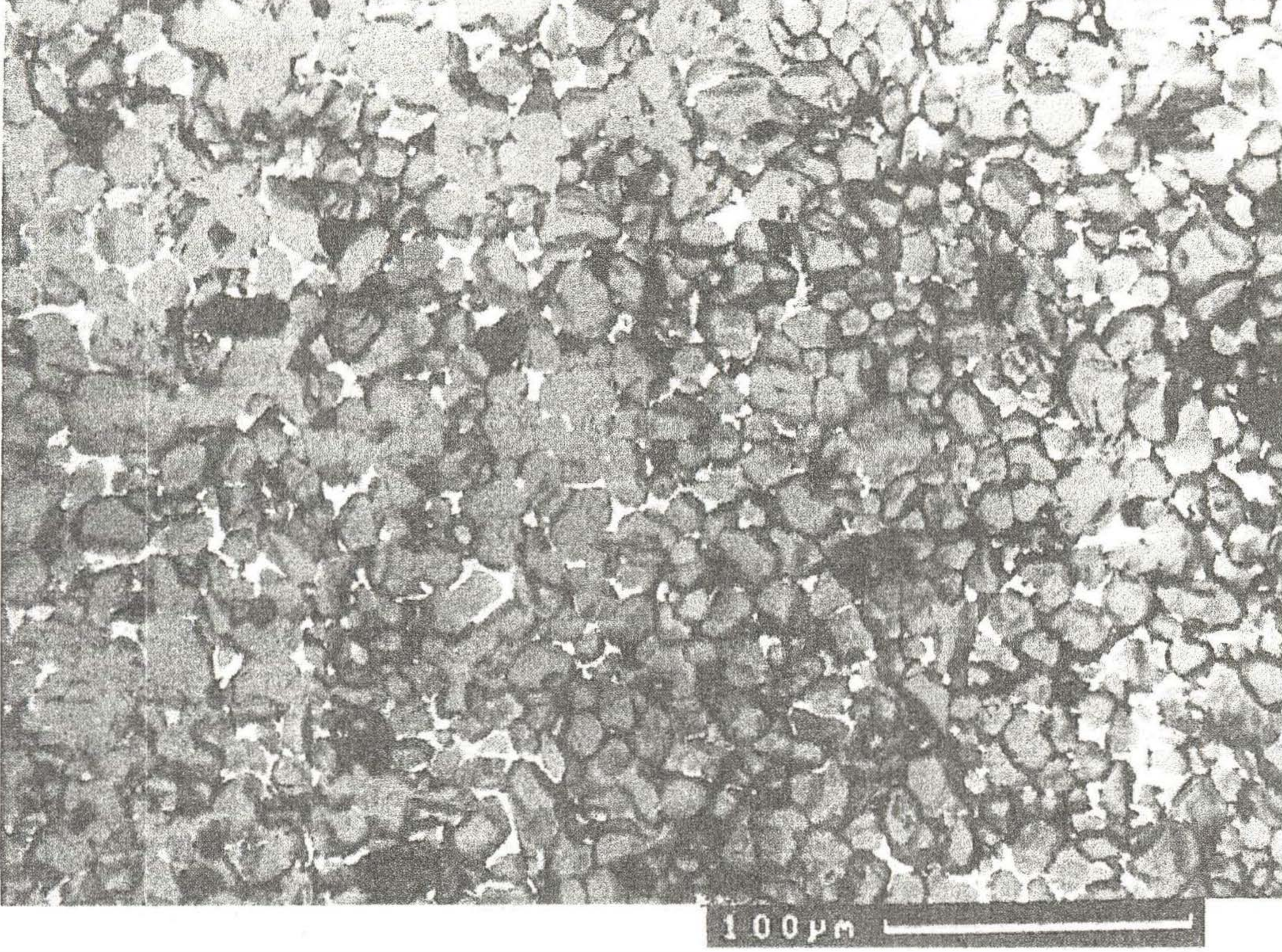
Şekil III.3. 1175°C'de 1 saat sinterlenmiş numunenin SEM görüntüsü.
