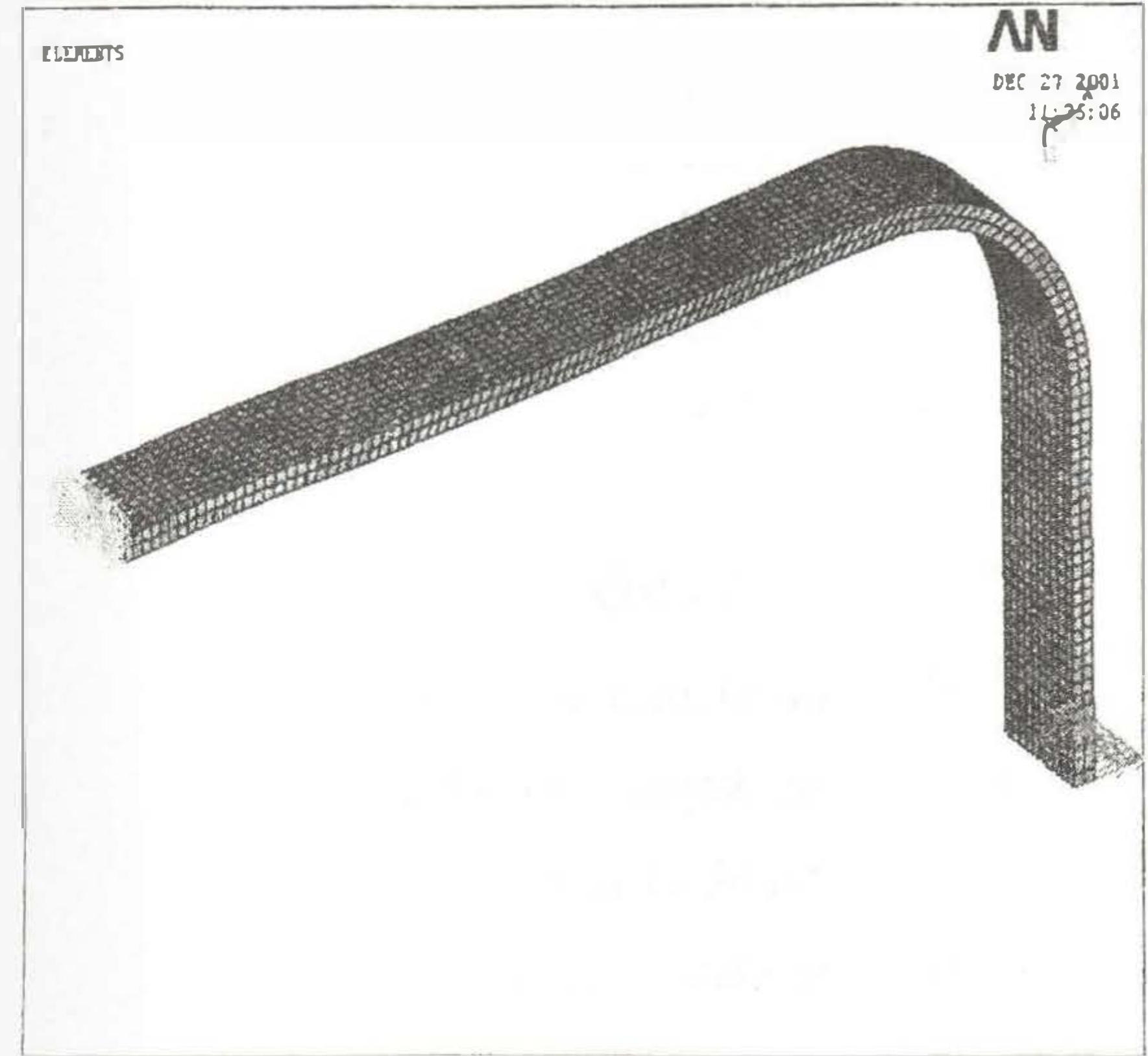
Şekil 16. Dikdörtgen kesitindeki eğrisel kirişin sınır şartları ve yüklemenin temsili gösterimi.
