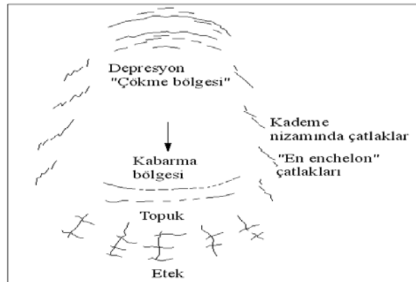
Şekil 2. Kohezyonlu Bir Zemin İçinde Meydana Gelen Dönel Çökme Tipi Bir Heyelanda, Tipik Olarak Meydana Gelen Çekme Çatlakları (Terzaghi ve Peck, 1948)
