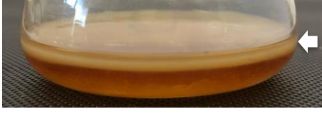
Şekil 1. H&S besiyerinin sıvı-hava ara yüzeyinde üretilmiş BS membranın görünümü.
