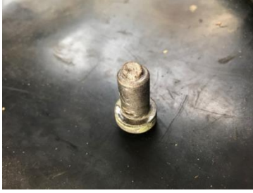
Şekil 2. Dinamik hasara uğramış bir bağlantı elemanı
