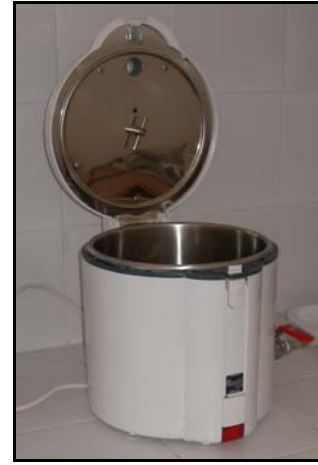
Şekil 3. Radobath kimyasal iz kazıma ünitesi
