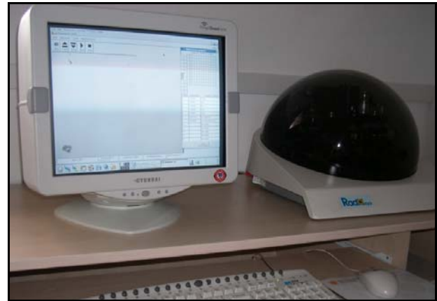
Şekil 4. CR-39 dedektörlerinin kayıt ettiği alfa yoğunluğunun belirlenmesi için SANAEM’de kullanılan görüntü işleme seti
