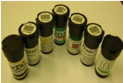
Şekil 1. CR-39 pasif nükleer iz dedektörlerini içeren farklı uygulamalara yönelik tasarlanmış çeşitli difüzyon kapları
