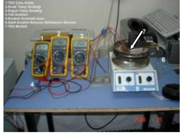
Şekil 5. TMG-450-0.8-1.0 elektriksel karakteristiğinin çıkarılması için kurulan deneysel düzenek
