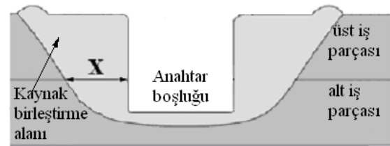
Şekil 1. Bir sürtünme karıştırma nokta kaynağının kesidi. x: Dikiş kalınlığı (Gerlich vd., 2005).
