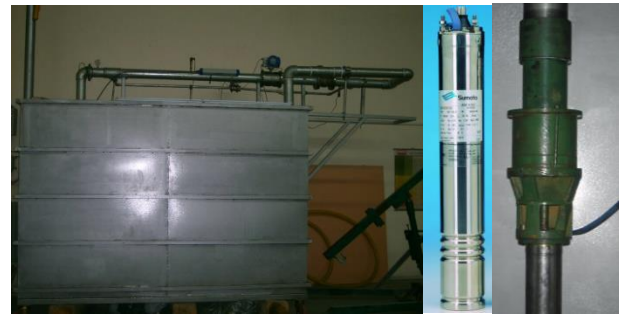
Şekil 3. Pompa deney düzeneği, dalgıç motoru, emme gövdesi ve emme kutusu
