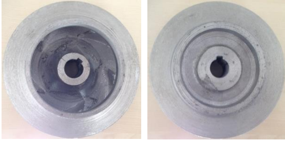
Şekil 2. Döküm yöntemiyle imalatı gerçekleştirilen çark ( Z=5, \beta_{2k}=30^\circ )
