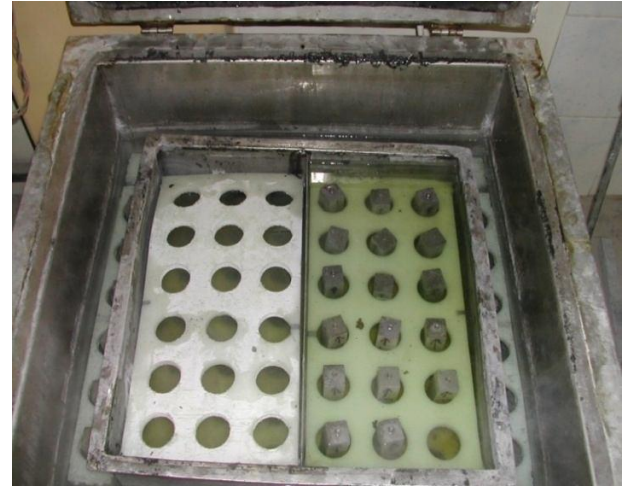
Şekil 2. ASR harç çubuğu örneklerinin 80°C sıcaklıkta NaOH çözeltisi içinde kür edilmesi
