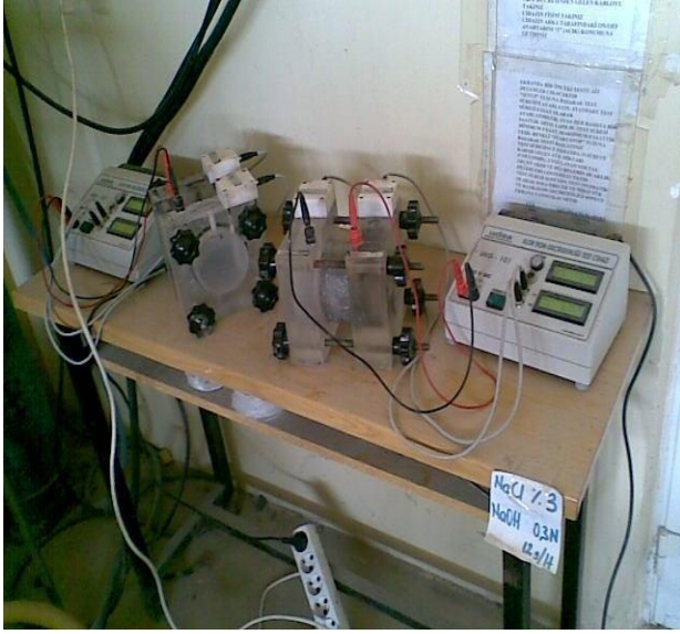
Şekil-1. Klor Geçirirliliği deneyi düzeneği
